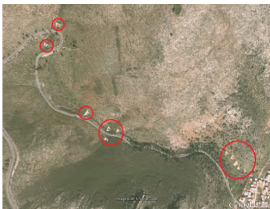
Фиг. 6.11 Поредица от бетонни язовирни прегради, построени над град Неа Макри няколко месеца след пожара на планината Пентели през 1995 г. (Google Earth изображение 2004)
